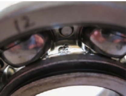
图 4 内圈点蚀故障 Fig. 4 Inner race pitting fault
